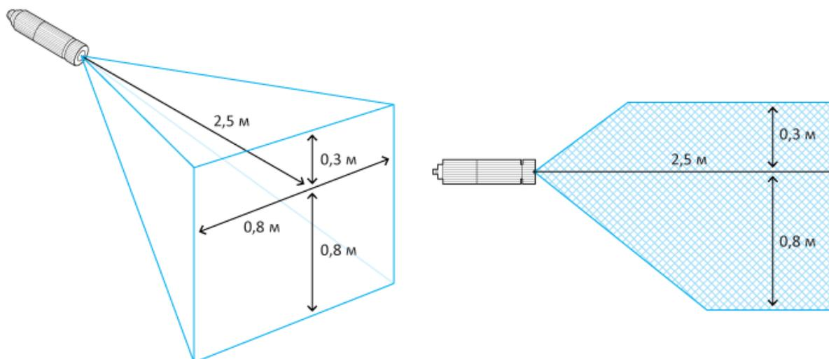
*Примечание: информация о размерах относится к форсункам с диаметром рабочего отверстия 0,15 и 0,20 мм. Значения могут меняться в зависимости от температуры, относительной влажности, движения воздуха и пр.*
